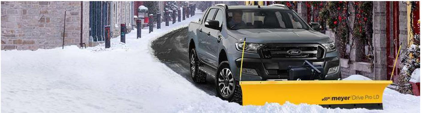
Las cuchillas Meyer **"DRIVE PRO"** se fabrican con dos posibilidades de anclaje sobre el vehículo portador, siendo el más utilizado el denominado **Quick link** que permite un montaje y desmontaje rápido y que a su vez consigue dotar al conjunto de una mayor ligereza.
